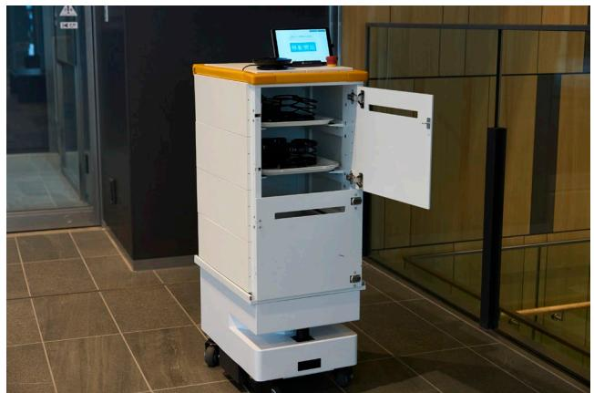
EXPO 会場である「コングレススクエア羽田」から、HANEDA INNOVATION CITY® 2 階ゾーン K 周辺にある異種複数台のロボット（清掃ロボット・運搬ロボット計 2 台）を遠隔で管理・操作するデモンストレーションを実施。3 次元仮想空間（デジタルツイン）上でロボットの位置情報をリアルタイムに把握し、一人のオペレーターが複数台を制御する技術は、人とロボットの能力を最大化し、業務効率を飛躍的に向上させ、人手不足等の課題を抱える業界でのソリューションとして注目を集めしていました。
